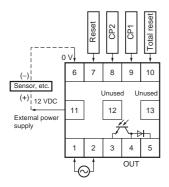
H7CX-A11/-A114/-A11D1/-A114D1 1-stage Contact Output
